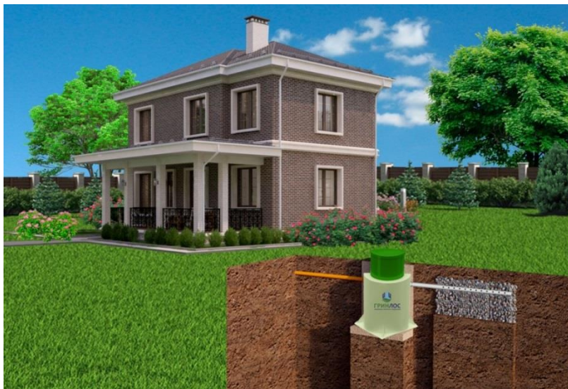
Рисунок 12. Монтаж с отводом очищенных сточных вод в фильтрующий колодец
