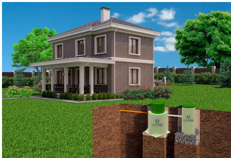
Рисунок 12. Монтаж с отводом очищенных сточных вод в фильтрующий колодец
