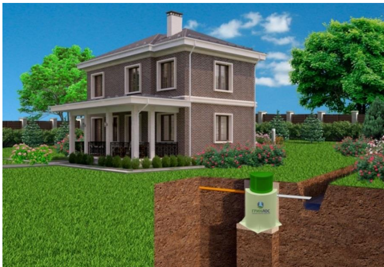
Рисунок 10. Монтаж с самотечным отводом очищенных сточных вод в дренажную канаву
