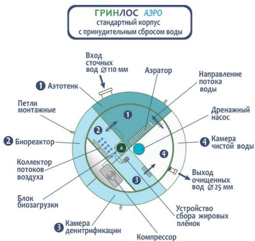
Рисунок 4. Технология очистки стоков в моделях со стандартным корпусом и принудительным сбросом
